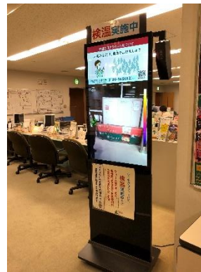
大型モニター付きサーモグラフィー
